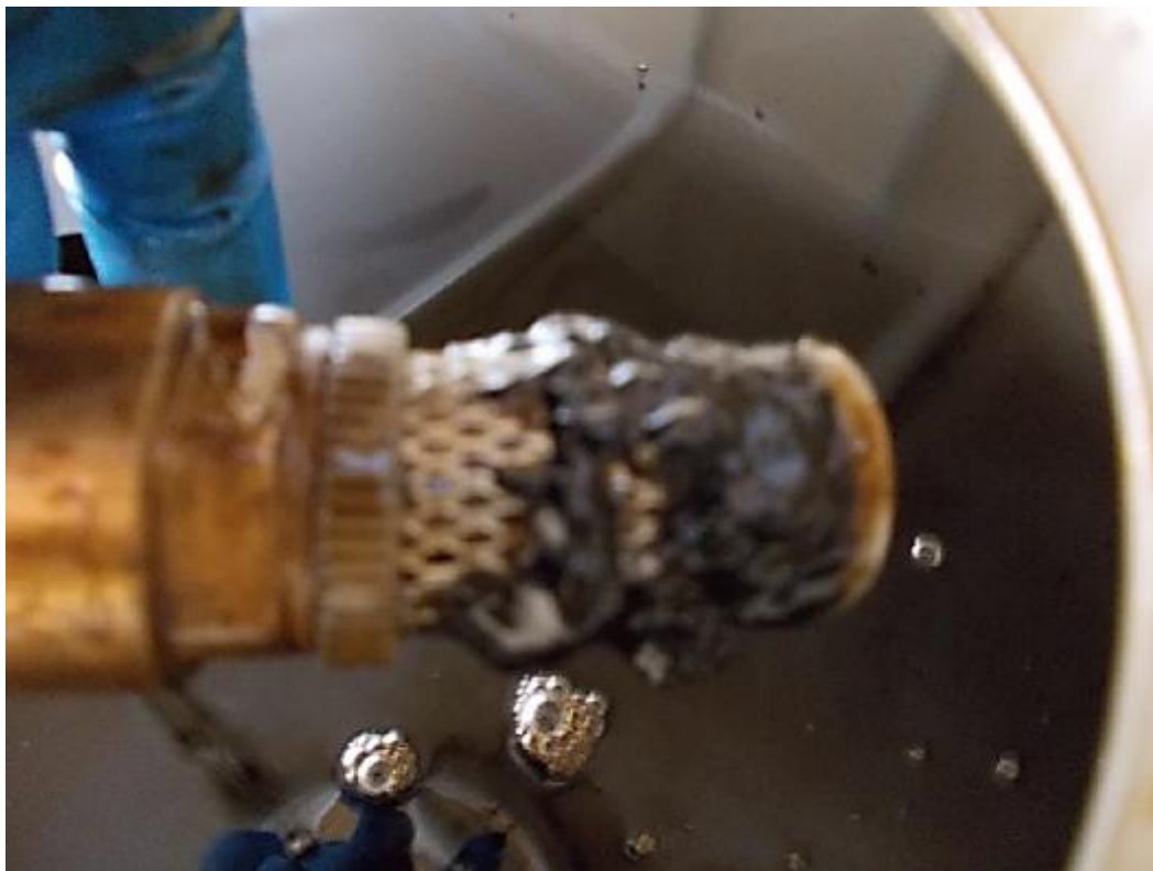
Abbildung 8 Bildung von hochviskosen Phasenbestandteilen am Einlaufsieb
