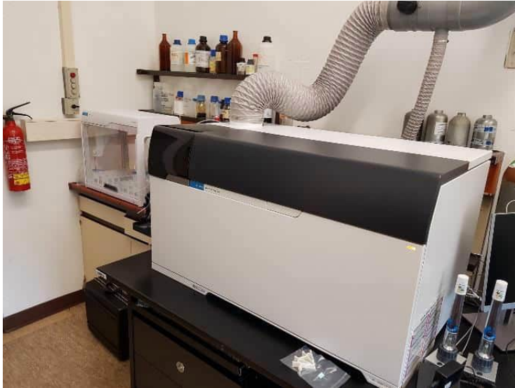
Abbildung 4-8: ICP-MS/MS Gerät in der Arbeits-, Sozial- und Umweltmedizin des LMU Klinikums München
